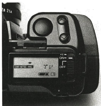
Kontrolpanelet på kameraet er omgivet af de vigtigste funktionsknapper: Hovedafbryder, udløserknap, programomskifter, lukkertidsknapper (op/ned) og i bunden anes c/s omskifteren for enkeltbillede/serieoptagelser. Panelet viser nu, at der er indstillet på det specielle TV-program for europæiske TV-systemer.
